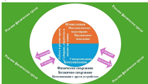
Фигура 6: Надграден модел с безжично свързване, комуникация с други устройства и предвидимо поведение модел
