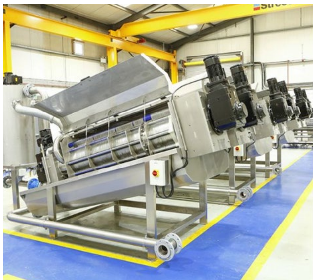
Фиг. 8 Шнек преса за обезводняване на дигеста
